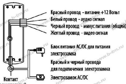
**Примечание:** панель имеет нормально открытый (N.O.) контакт. Это значит, что в исходном состоянии сухой контакт (контакт соединительный) разорван и замок в закрытом состоянии. При нажатии кнопки "открытия" на домофоне контакт замыкается, напряжение питания подается на замок и замок открывается.
